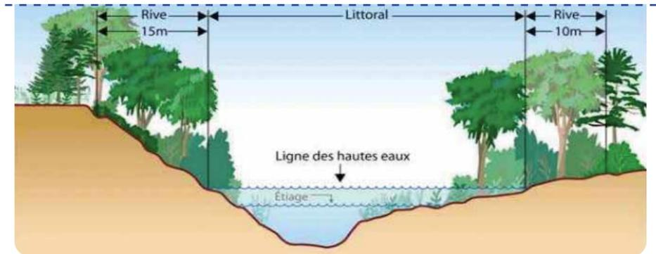
et à une distance de 15 mètres avec plus de 30 % d'inclinaison (voir l'image), il est strictement interdit d'aménager, construire et tondre le gazon dans la bande riveraine. Elle doit rester à l'état naturel afin de favoriser son service écologique de filtration des eaux de ruissellement, de diminution de l'érosion, d'abris pour la faune, etc.
